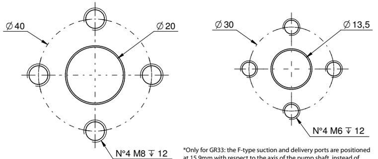
\*Only for GR33: the F-type suction and delivery ports are positioned at 15.9mm with respect to the axis of the pump shaft, instead of 13.75mm like the other types of connections / Solo per GR33: le porte di aspirazione e di mandata di tipo F sono posizionate a 15,9mm rispetto all'asse dell'albero della pompa, anziché 13,75mm come le altre tipologie di connessione
