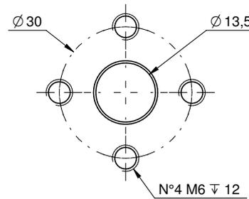
UNF INLET OUTLET PORTS / PORTE DI ASPIRAZIONE E MANDATA UNF - **Type U / Tipo U**
